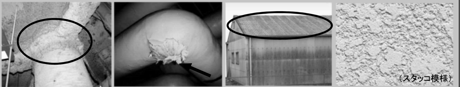
石綿含有断熱材・保温材・耐火被覆材(レベル2)
